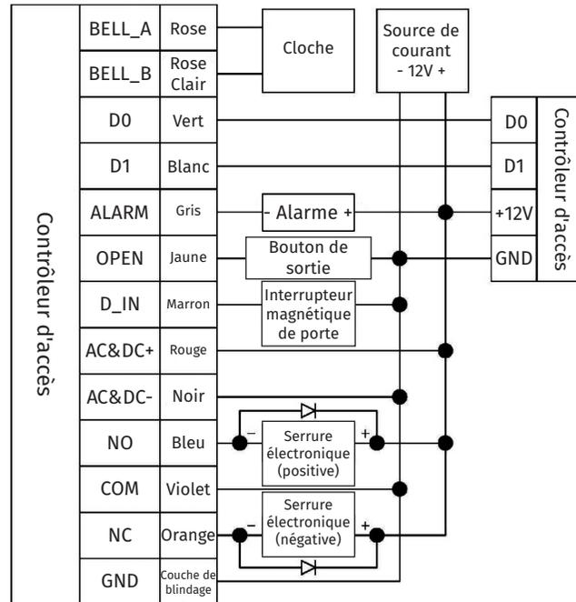
Schéma des connexions de l'alimentation du contrôle d'accès
